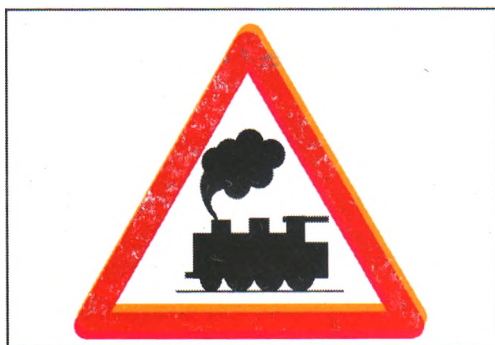
Passage à niveau non gardé
